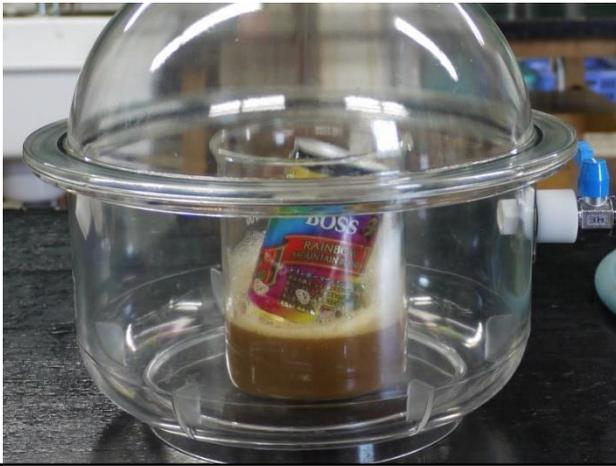
**減圧したデシケーター内の飲料缶。底面の穴から出てきた液体がビーカーに溜まっている。加圧すると液体は缶内に入り、元どおりになる。**
