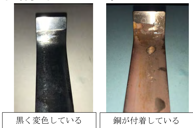
図 11：反応させてから 30 分後の各電極の様子
