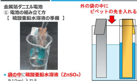
図 21 説明シート④（硫酸亜鉛水溶液の準備）
