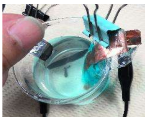
図 5 塩化カリウム寒天を使用しない場合の実験
