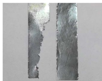
図 25 実験後(左)と 実験前(右)の亜鉛箔
