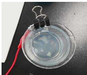
図 7 塩化カリウム寒天を使用した場合の実験
