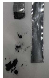
図 11 実験後(左)と実験前(右) の亜鉛箔の比較
