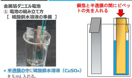
図 20 説明シート③（硫酸銅水溶液の準備）
