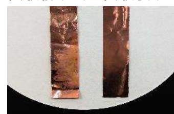
図 27 実験後(左)と 実験前(右)の銅箔
