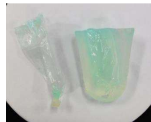
図 9 寒天付セパレータの断面
