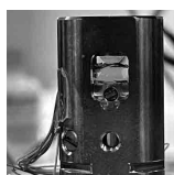
試料に数十万気圧の圧力をかけて測定を行っている様子
